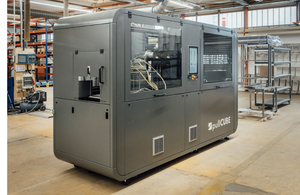
Mit 3,5 Metern ist der pullCUBE die kürzeste Pultrusionsmaschine der Welt
